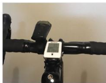
サイクルコンピュータ 自転車に取り付け、 速度、走行距離などを計る機械。
